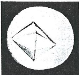
Un cristal de glace VI, de structure quadratique, en équilibre avec l'eau liquide à 0.9 GPa et à température ordinaire (295 K soit  $22^{\circ}\text{Celsius}$ ). Cette glace est plus dense que l'eau liquide dans les mêmes conditions.
